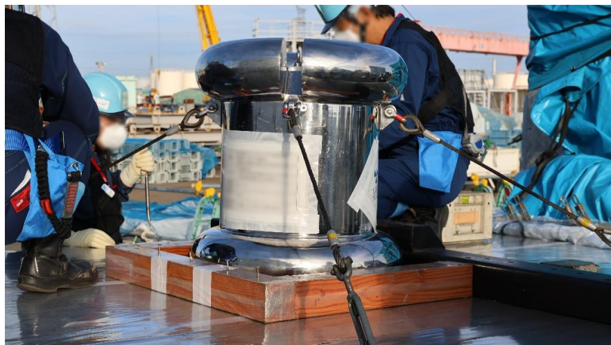
構外輸送車両に積載された構外輸送容器の状況
