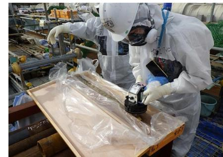
写真2 ボーリングコア表面線量測定状況
