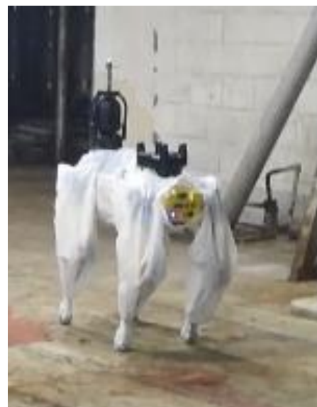
SPOT歩行状況 (保護具着用) 搭載機器: 通信機器, 360°カメラ
