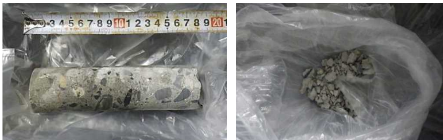
3・4号機廃棄物処理建屋から採取したコア・はつり試料
