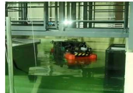
ROV航走試験 (狭隘部通過)
