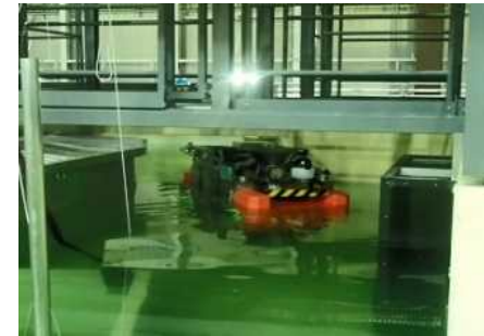
ROV航走試験 (狭隘部通過)
