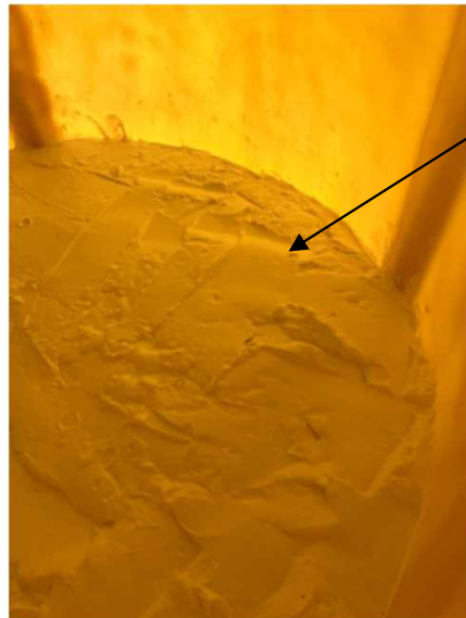
抽出し前のスラリーの状況 (上澄み水を抜き取り流動性が低い状態)
