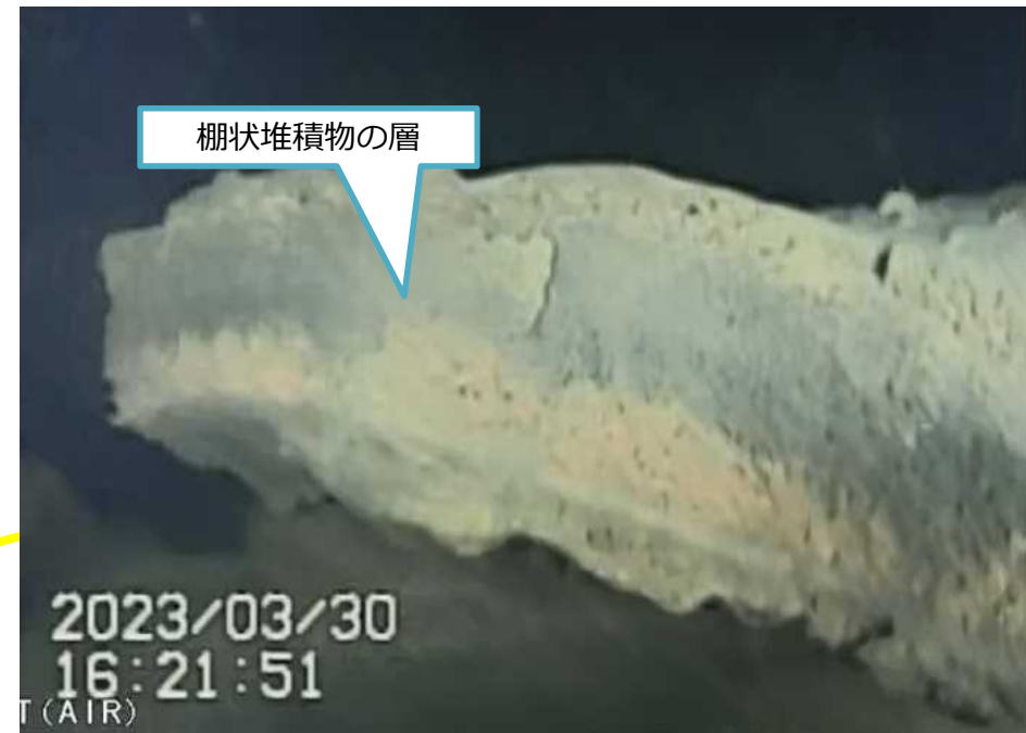
写真1. ペデスタル外棚状堆積物断面
