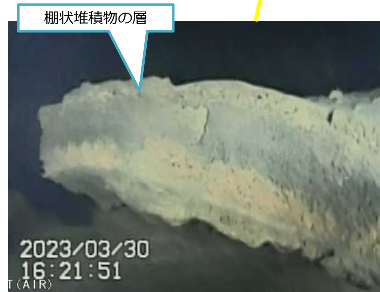
写真3. ペDESTAL外棚状堆積物断面
