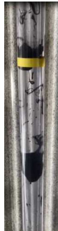
写真2：ポリブタジエン 自由落下
