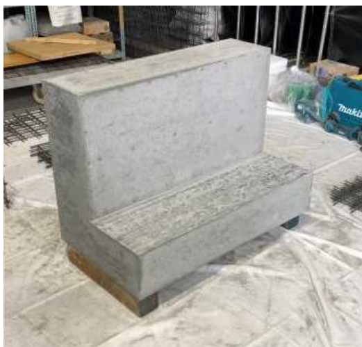
手順1：基礎L型部
