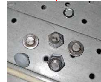
接合部のボルトが破断
