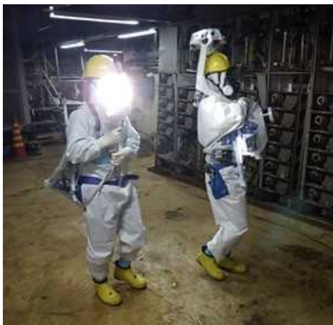
ウェアラブル型3Dスキャン装置 （4号機R/Bにおけるモックアップの様子）
