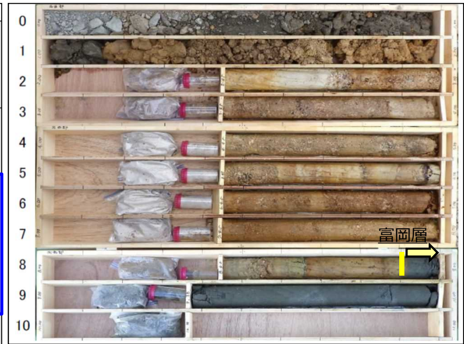
ボーリングコア
