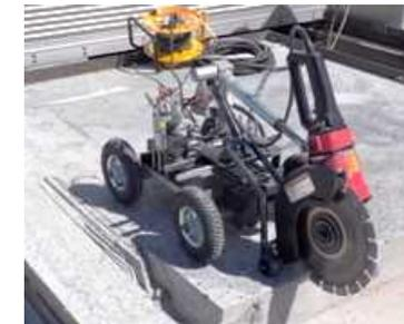
溝切ロボット(モックアップ機)
