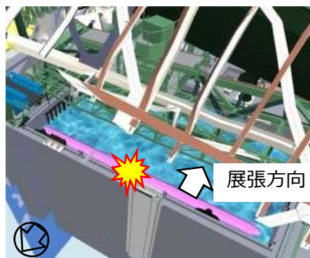
養生バッグ投入完了
