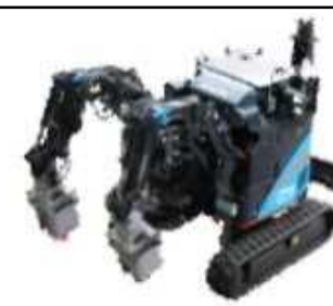
ASTACO-SoRa (双腕遠隔重機)
