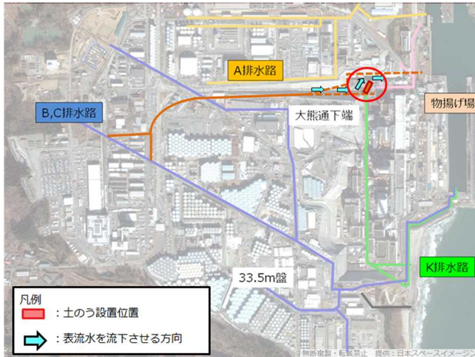
大型土のう設置
