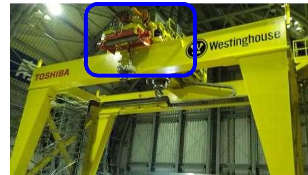
クレーン（○部：補巻）
