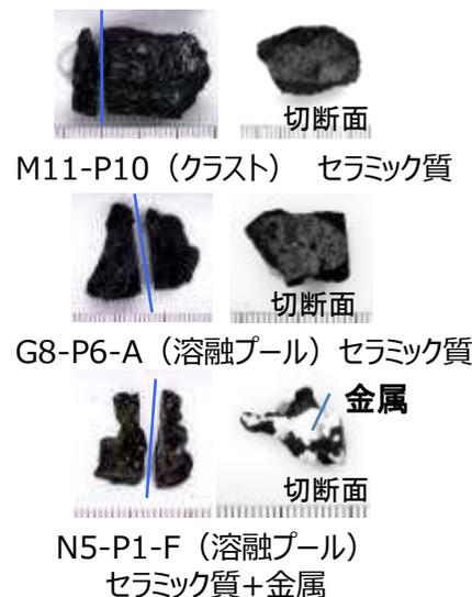
TMI-2燃料デブリ試料溶解試験結果
