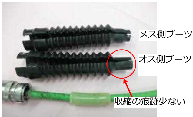
②ブーツの熱収縮状況
