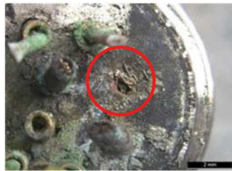
④断線部拡大 (異物除去後)
