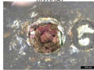
⑥断線部拡大 (清掃後)
