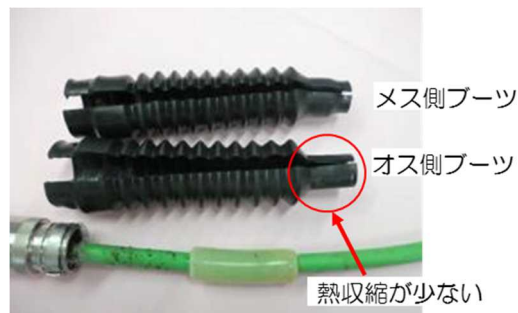
②ブーツの熱収縮状況
