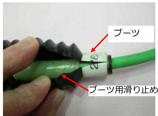
①ブーツ用滑り止めのずれ
