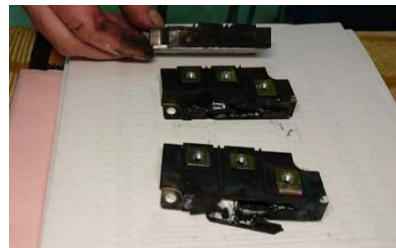
損傷の確認された整流器 (4月5日)
