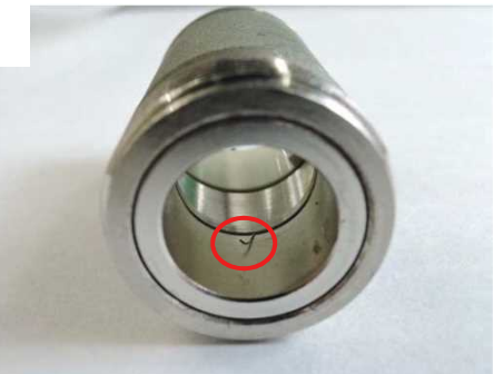
接続部内部のシールド線
