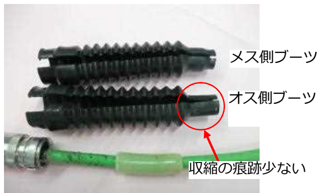
②ブーツの熱収縮状況
