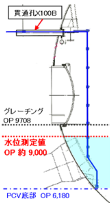
図 4.2.1-2 1 号機 D/W 内滞留水の水位測定結果 [1-4]
