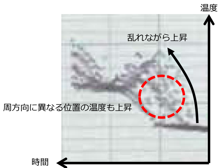
図 4-7 津波到達前の 2 号機の S/C プール温度 iv
