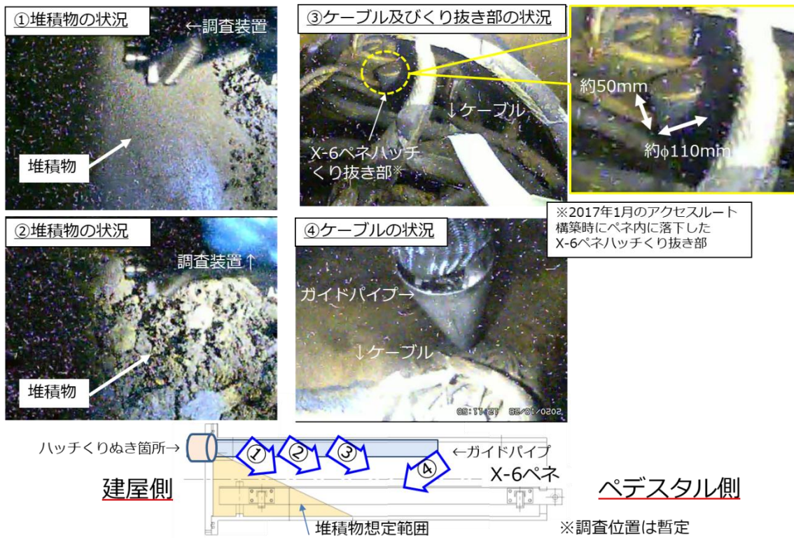
図 3-22 X-6 ペネ内堆積物の接触調査結果② [3-13]
