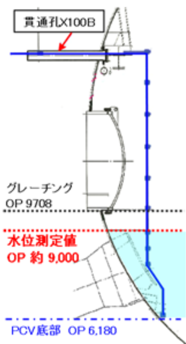
図 4.2.1-2 1 号機 D/W 内滞留水の水位測定結果 [1-4]
