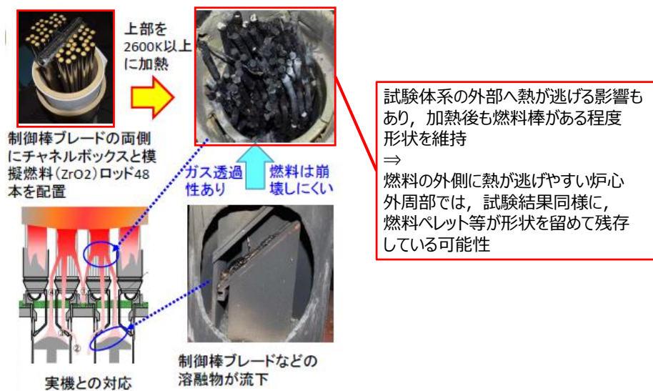
図 4.7.3-3 模擬燃料集合体破損試験 [3-3]
