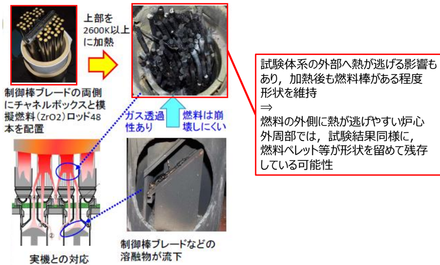
図 4.7.2-3 模擬燃料集合体破損試験 [2-14]
