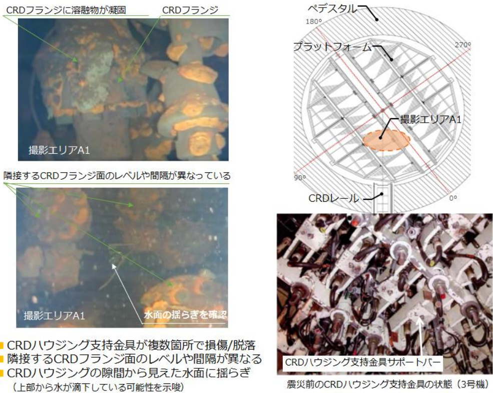
図 4.8.3-3 RPV 底部の様子 [3-15]
