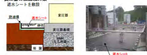
変圧器の油漏洩対策
