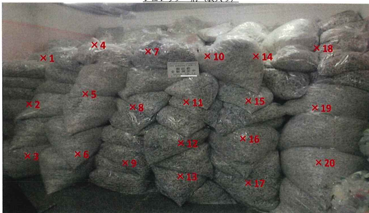
シュレツダー屑 表面線量率測定結果 ( \mu\text{Sv/h} )
