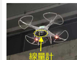
ドローンへの線量計設置状況 ※撮影場所：東京電力ホールディングス(株) 経営技術戦略研究所
