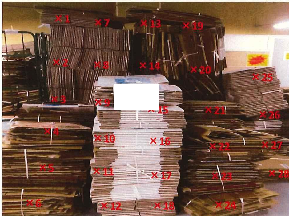
段ボール 表面線量率測定結果 ( \mu\text{Sv/h} )
