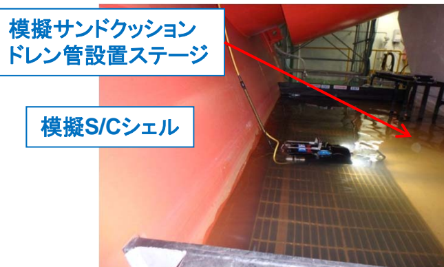
サンドクッションドレン管調査装置工場試験
