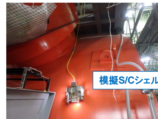
S/C下部外面調査装置工場試験
