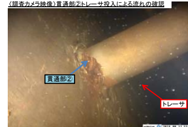
〈調査カメラ映像〉貫通部②トレーサ投入による流れの確認
