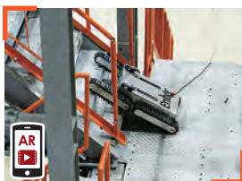
モーターを各々内蔵したクローラ きょうら で急勾配の階段を力強く昇っていく一関高専のロボット
