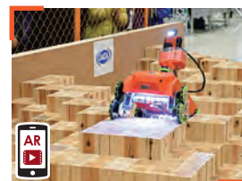
クローバの形に組んだ車輪 くるい で凹凸の段差を力強く進む一関高専のロボット
