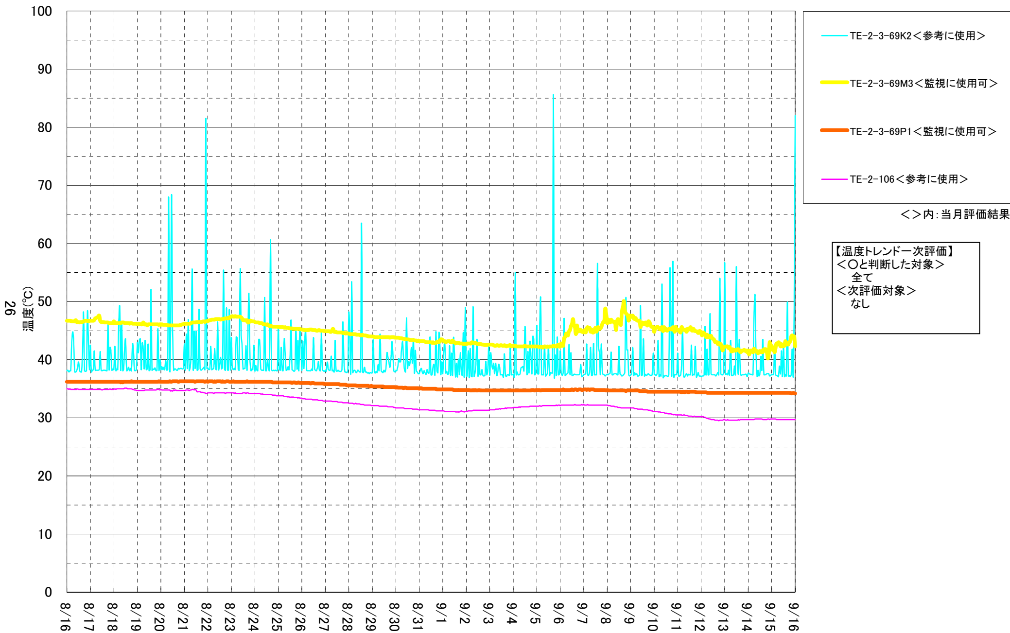
2号機 RPV周辺温度計(下部)
