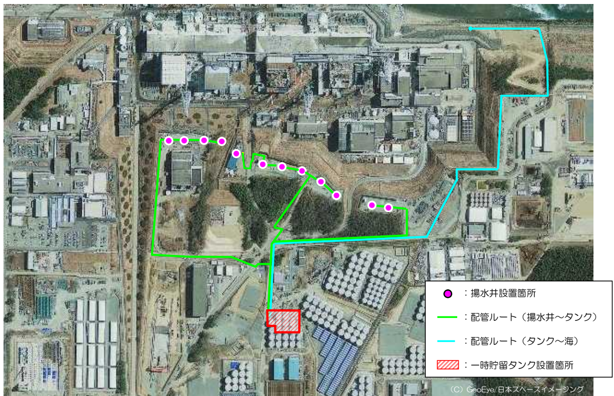
図2 地下水バイパスの設備
