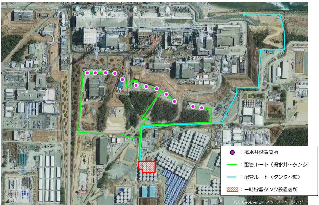
図2 地下水バイパスの設備
