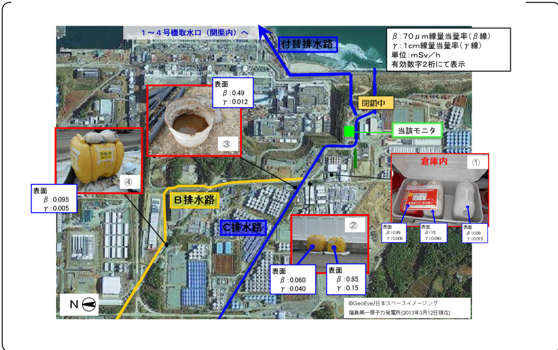
【図2：汚染水処理設備以外の設備からの漏えいの調査結果】
