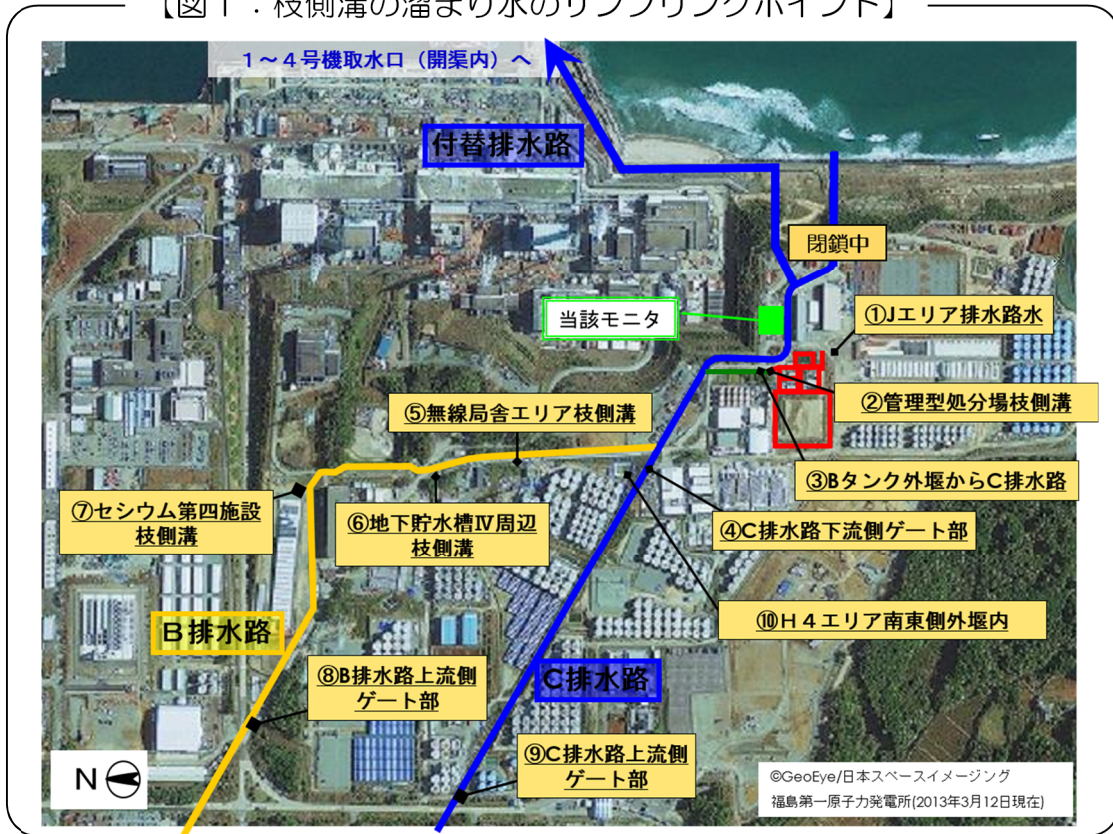
【図1：枝側溝の溜まり水のサンプリングポイント】
