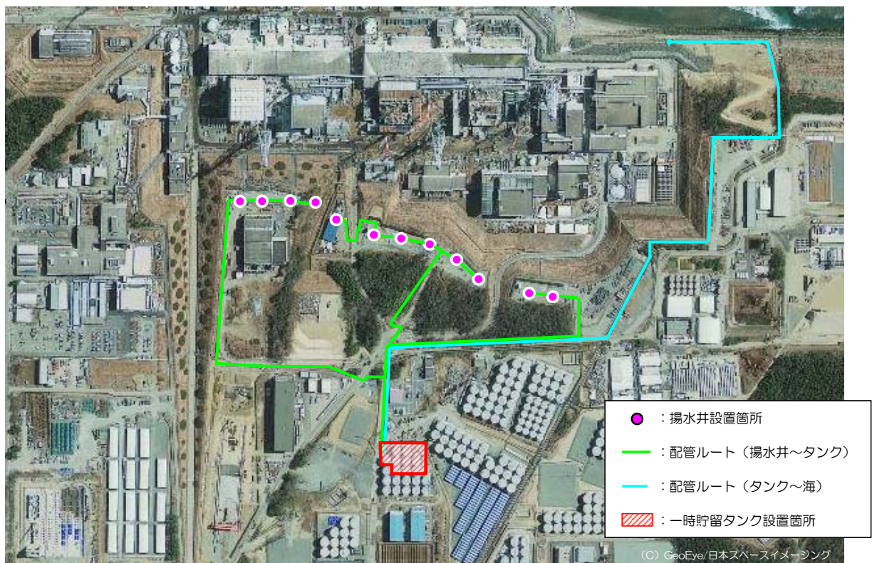
図2 地下水バイパスの設備
