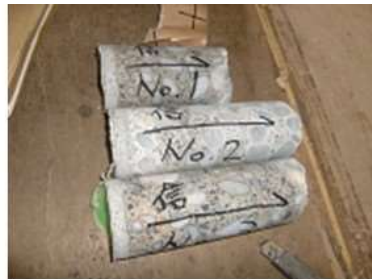
コンクリート強度試験体採取状況
