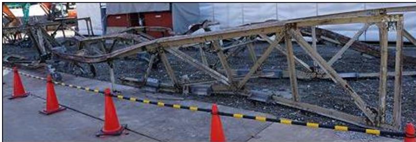
② 崩落した鉄骨トラス梁(1組)の状況
