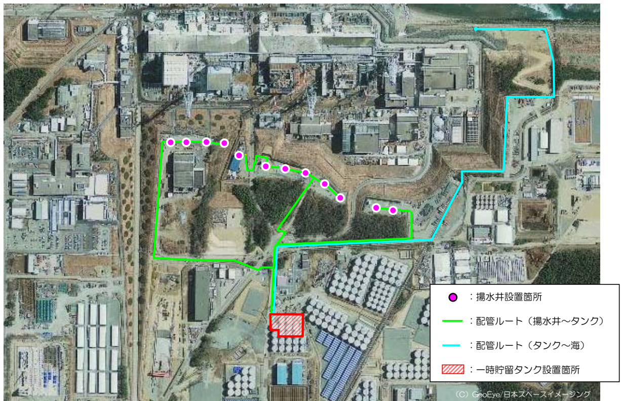
図2 地下水バイパスの設備
