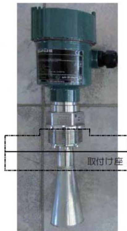
写真9 レーダー式水位計
