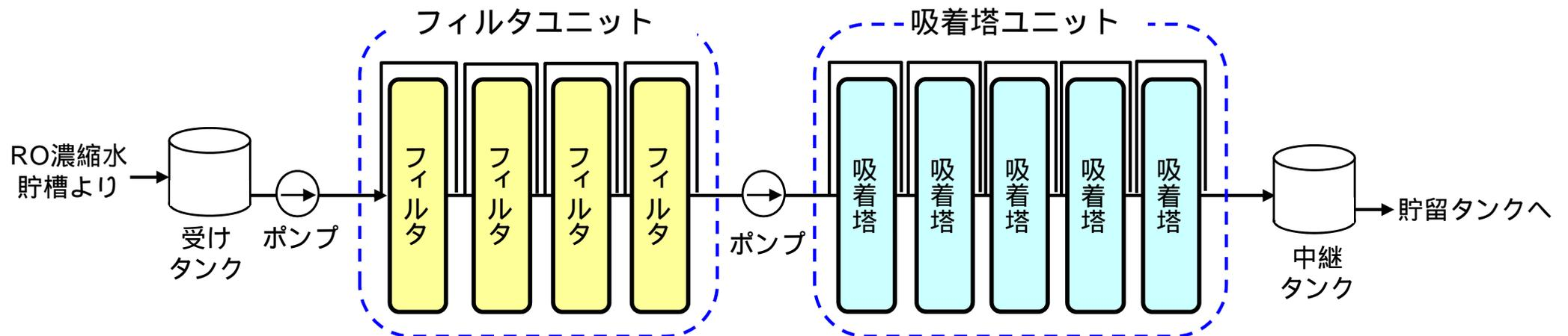
処理対象水の放射能濃度等に応じてフィルタ，吸着塔のバイパス運転を実施
