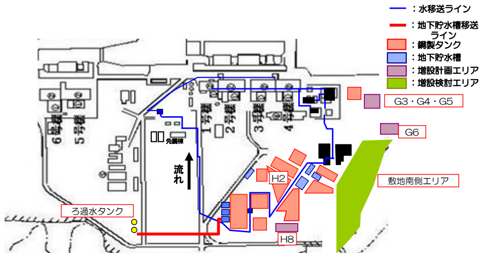
図-4 No.1 ろ過水タンクへの移送ライン概略図
