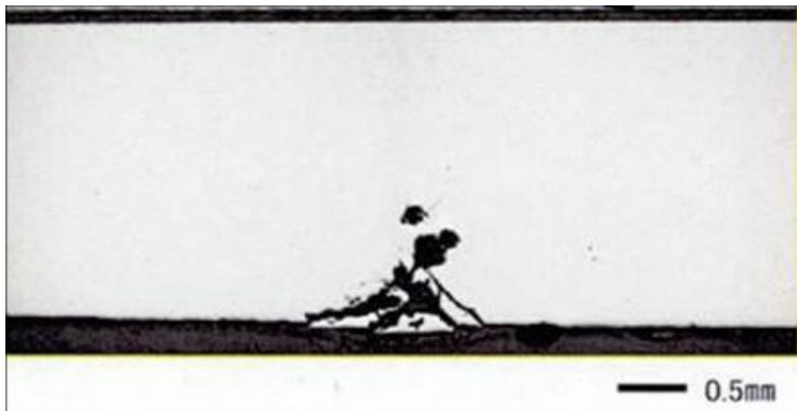
図 4 - 5 腐食試験結果 (試験片①, 照射材) : 照射影響の確認 (90°C 塩化物イオン濃度 : 2500ppm, 2000 時間浸漬) (上部端栓は照射材, その他は未照射材)
