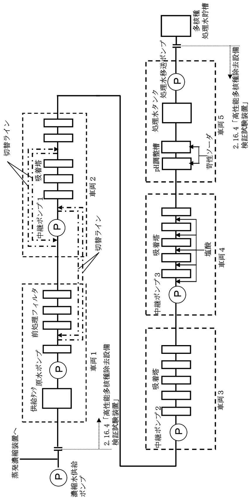
図-2 高性能多核種除去設備検証試験装置の系統構成図
