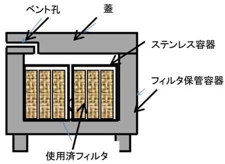
図6 フィルタ保管容器の概要図
