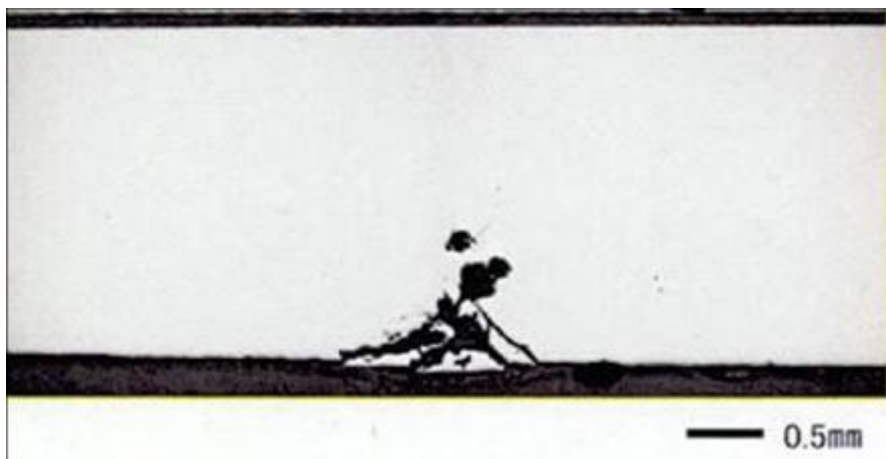
図 4 - 5 腐食試験結果 (試験片①, 照射材) : 照射影響の確認 (90℃ 塩化物イオン濃度 : 2500ppm, 2000 時間浸漬) (上部端栓は照射材, その他は未照射材)
