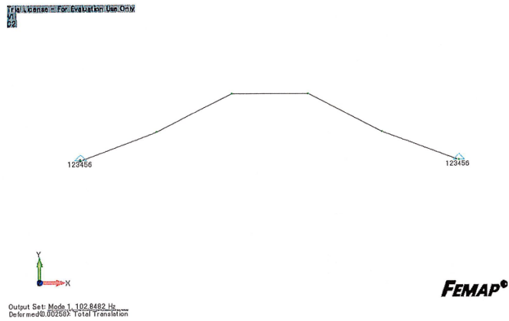
図 5.2.4-1 両端固定梁の解析結果（固有振動数）
