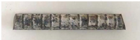
No.3 (腐食グレードI)
