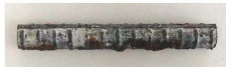
No.1 (腐食グレードII)
