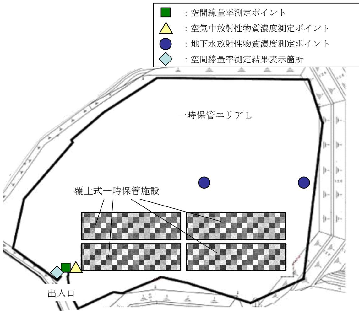
図 2. 1. 1-2 覆土式一時保管施設における測定ポイント，測定結果表示箇所予定位
