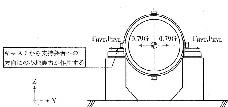
図3 鋼製支持架台に作用する荷重
