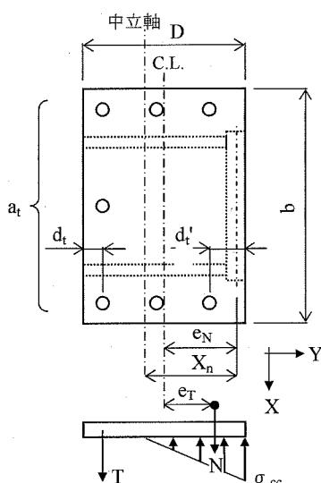
図 14 計算モデル図（基礎ボルト）
