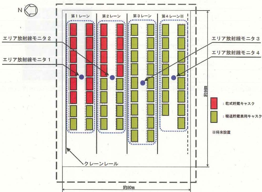
図 1 エリア放射線モニタ配置図
