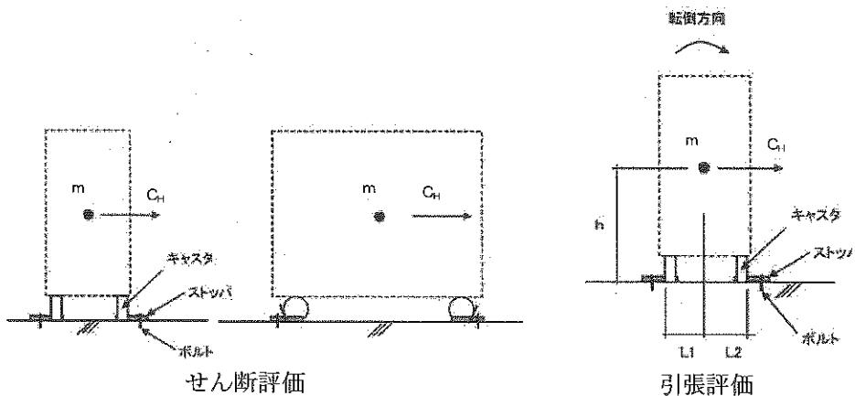
表-7 フィルタユニットの基礎ボルトの強度評価結果
