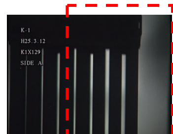
C面からの透過光による 燃料棒-ウオータ・ロッド間隔の A面からの確認
