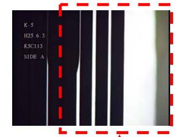
C面からの透過光による燃料棒-ウォーター・ロッド間隔のA面からの確認
