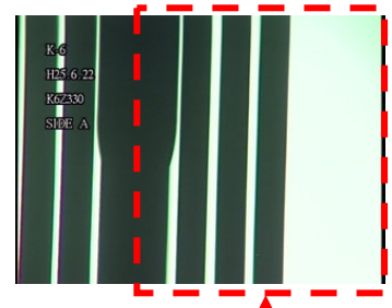
C面からの透過光による 燃料棒-ウオーター・ロッド間隔の A面からの確認
