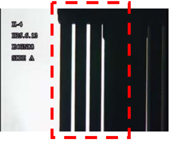
C面からの透過光による 燃料棒-ウォータ・ロッド間隔の A面からの確認
