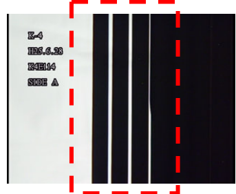
C面からの透過光による燃料棒-ウォータ・ロッド間隔のA面からの確認
