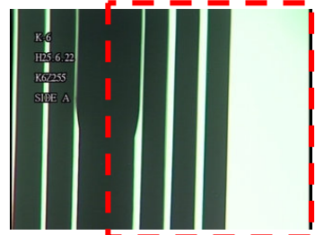
C面からの透過光による 燃料棒-ウオータ・ロッド間隔の A面からの確認
