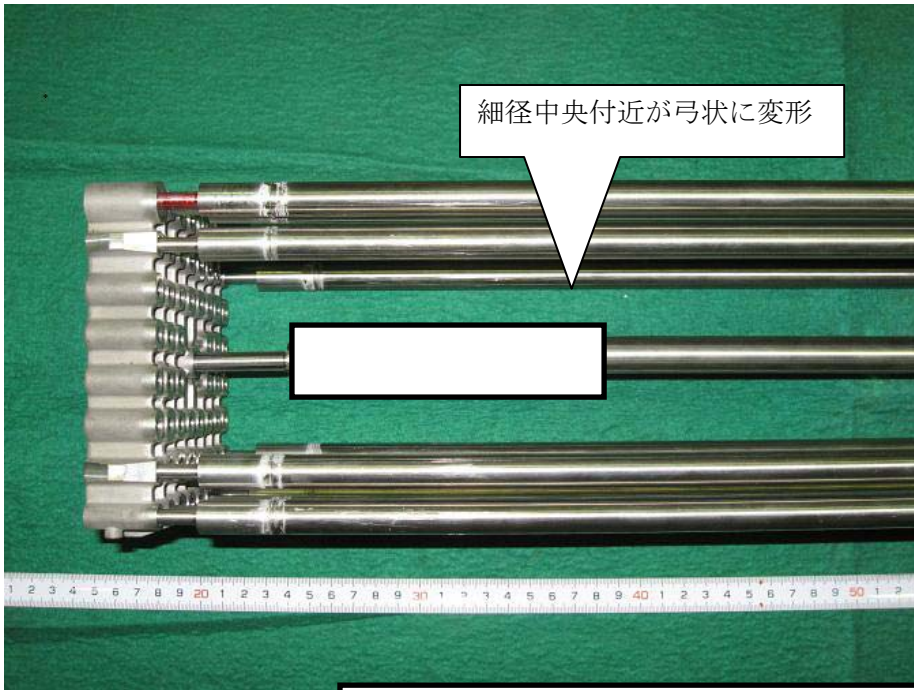
図3-5 試験後の供試体観察結果（上部WR：一撃落錘試験）
