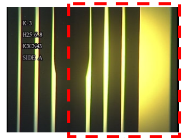
C面からの透過光による 燃料棒-ウォーター・ロッド間隔の A面からの確認
