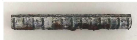
No.1（腐食グレードII）
